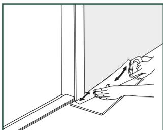
Når det nye gulvbelegget møter en terskel eller dørkarm, anbefaler vi å underskjære dørkarmene eller listene. For å være sikker på korrekt snitt, må du snu planken opp-ned med underlaget under og legge den på gulvet opp mot dørkarmen. Dette sørger for at snittet gjøres i korrekt høyde. Plasser deretter et multiverktøy eller en håndsag flatt mot planken og sag gjennom rammen. Fjern biten som er saget ut og støvsug bort alt rusk.
