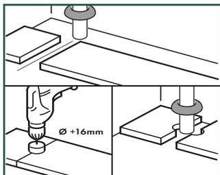
I rader der det er et rør, må du sørge for at røret faller nøyaktig på linje med kortsiden av to planker. Bruk et bor med samme diameter som røret pluss 16 mm. Klikk plankene sammen på kortsiden og bor et hull sentrert på skjøten mellom de to plankene. Nå kan du montere plankene.
