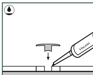
Fest ekspansjonsprofilen til undergulvet med Pergo Multiglue. Påfør fleksibelt Sealant på PE-skummet som er i ekspansjonsskjøten.
