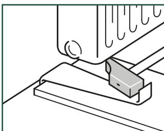
På steder der det er vanskelig å montere plankene med slagklossen (f.eks. under radiatorer), kan du banke dem sammen ved bruk av trekkjernet og en hammer.
