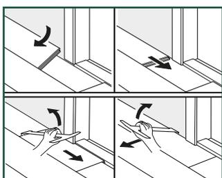
Når du sager til panelene må du sørge for at ekspansjonsåpningen under døren er på minst 8 mm.
