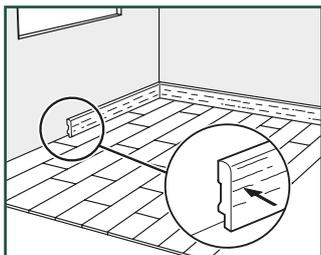
Monter gulvlistene mot veggen. Listene må aldri festes til gulvet. Denne metoden tillater at gulvet kan utvide og trekke seg sammen under listen.
