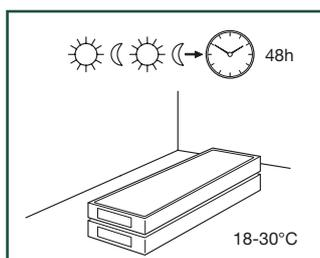
Rigid Pergo-vinylgulv må alltid lagres og transporteres med omhu for å forhindre deformering. Eskene bør lagres og transporteres på flatt underlag i ryddige stabler. Eskene må aldri lagres stående eller i fuktige eller støvete rom. Eskene må ikke lagres på meget kalde (<5 °C), veldig varme (> 35 °C) eller fuktige steder.
