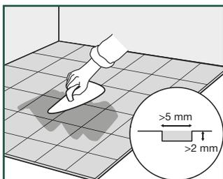
Fuger mellom fliser eller andre åpninger med en dybde på mer enn 2 mm og bredde på 5 mm bør jevnes ut.
