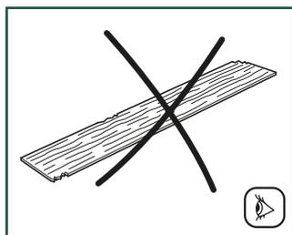
Kontroller alle panelene under optimala lysforhold før og under leggingen. Defekte paneler må aldri brukes. Et lagt panel betraktes som godkjent og kan ikke reklameres.
