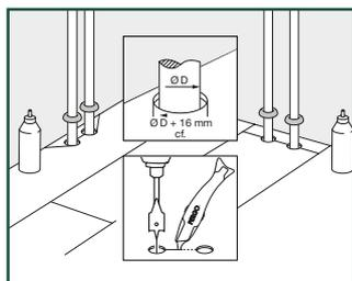
I rader der det er et dobbeltrør, skal du gå videre som følger: 1. Mål hvor røret vil komme gjennom planken. Ikke glem å beregne plass til ekspansjonsskjøten. Mål diameteren på røret, pluss 16 mm for ekspansjon 2. Bor gjennom panelet der røret vil komme gjennom 3. Forleng hullet til kanten på panelet 4. Legg panelet rundt røret
