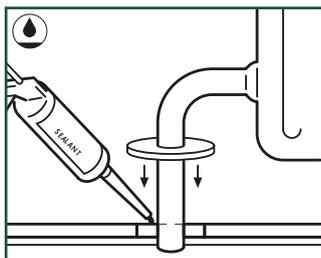
For perfekt finish rundt rørene, bruk Pergo-rørdeksler og elastisk, vanntett og transparent Pergo Sealant, og ta hensyn til ekspansjonen på 8 mm. Plasser skumremsen i ekspansjonsskjøtene. Påfør Sealant på skumremsen. Sett deretter på plass rørdekslene for flytende gulv.
