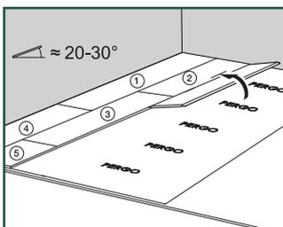
Etter montering av hver planke og før du fortsetter med neste planke, må du kontrollere skjøten på hver kort- og langside for å være sikker på at det ikke er noen høydeforskjeller og ingen åpninger.
