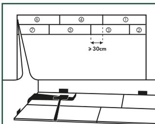
På steder der det er for vanskelig å montere Uniclic®-plankene med slagklossen (f.eks. mot vegg), kan du trekke dem sammen ved bruk av trekkstangen og en hammer.
