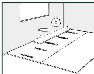
Med Rigid Pergo-vinylklikkpaneler kan du velge hvor i rommet du vil begynne. Tenk på hva som vil være den enkleste måten å montere gulvet på. Vi vil demonstrere montering av Rigid Pergo-vinylgulv for høyrehendte personer, fra høyre mot venstre (sett forfra). På grunn av Uniclic-klikksystemet kan du arbeide i begge retninger.
