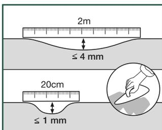
For Rigid Pergo-vinylgulv med klikksystem: eventuelle ujevnheter på mer enn 1 mm over en lengde på 20 cm må utjevnes. Det samme gjelder ujevnheter på mer enn 4 mm over en lengde på 2 m.
