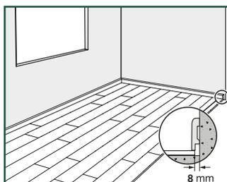
Romtemperaturer varierer kontinuerlig, og derfor er det viktig at gulvet kan ekspandere og trekke seg sammen. Av den grunn må du sørge for å etterlate en ekspansjonsåpning på 8 mm på alle sider av gulvet, rundt rør, terskler og under dørkarmer. Ekspansjonsåpninger kan ferdiggjøres ved bruk av lister som festes til veggene eller med en ekspansjonsprofil. I de fleste tilfeller trenger du ikke ekspansjonsprofil mellom forskjellige rom. Imidlertid er bruk av ekspansjonsprofil obligatorisk når
