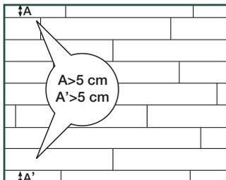
Før du starter, må du måle lengden og bredden på gulvet nøye, slik at du kan legge en presis plan for å gi gulvet et balansert utseende. Det er meget viktig ved montering av typisk flisdekor. Dette vil også sørge for at du ikke vil ende opp med at den siste raden er for smal. Hvis den siste raden vil være smalere enn 5 cm, blir monteringen enklere hvis du reduserer bredden på plankene i den første raden.
