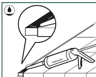
Tetting av omkretsen rundt ekspansjonsskjøter gjøres med en kombinasjon av komprimerbart PE-skum og fleksibel og vanntett Pergo Sealant. Legg PE-skum i ekspansjonsfugene ved hjelp av den selvklebende baksiden, og påfør den fleksible Pergo Sealant litt vinklet mot Pergo-gulvet. Sørg for at Sealant dekker cirka 1 til 2 mm av veggen, hele skumstripen og 1 til 2 mm av gulvet.
