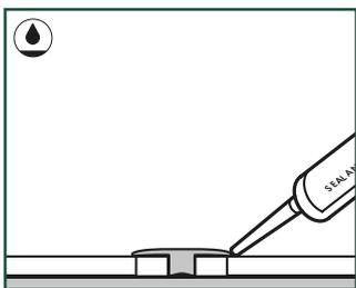
Skyv Incizo-profilen inn i grunnprofilen og det våte Sealant-kittet. Påfør også Sealant der ekspansjonsprofilen berører gulvet, for perfekt vanntetting.
