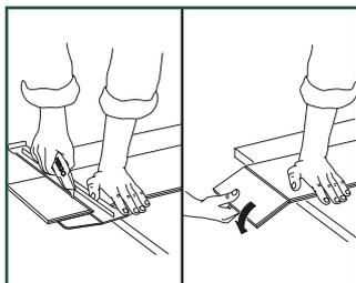
Hvis du trenger å avkorte planken med et rett snitt, kan du skjære Rigid Pergo-vinylgulv med dekorsiden vendt opp med en konkav spesialkniv for vinyl. Når du skal skjære over vinylplanken skal du trekke en rett linje å skjære langs og bruk kniven til å lage et bestemt snitt i overflaten. Du trenger aldri å skjære helt i gjennom vinylen. Brekk deretter av planken med begge hender.
